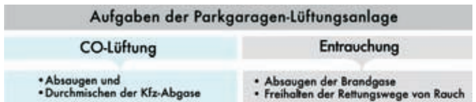
Bild 3: Aufgaben einer Abluft-Anlage für Tiefgaragen
