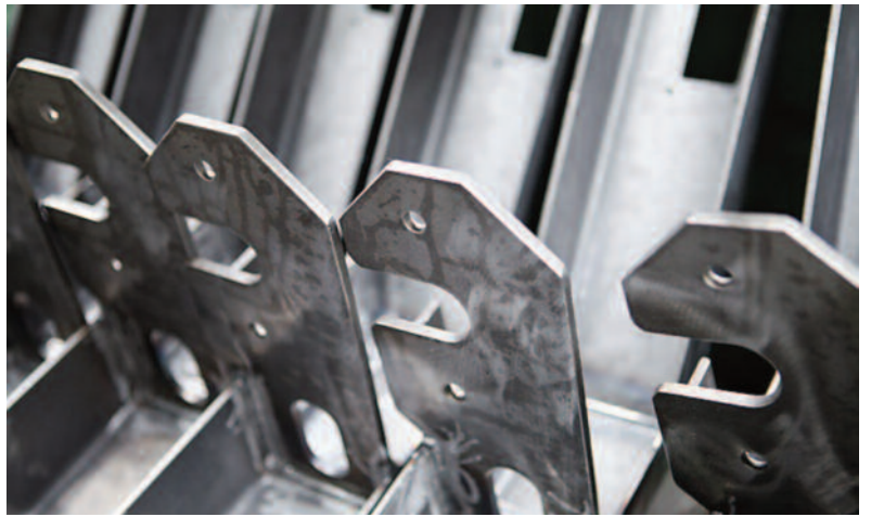
Stahlbauteile vor der Pulverbeschichtung
