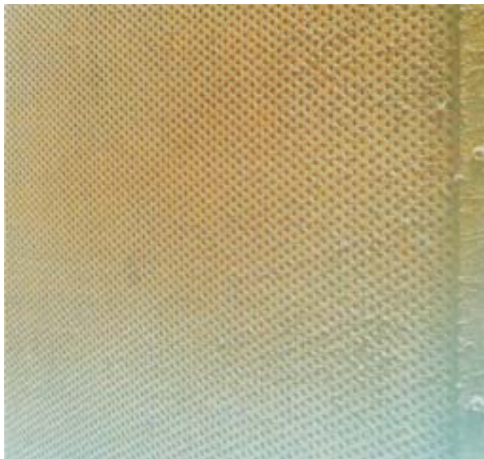
Unten: Großaufnahmen von Absorptions-Kulissenwänden nach ca. 11 000 Betriebsstunden.
