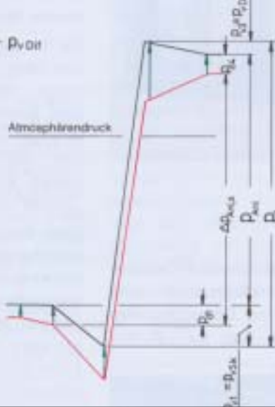
Bild D-4: Frei ausblasendes Gebläse (z. B. Grubenlüfter)
