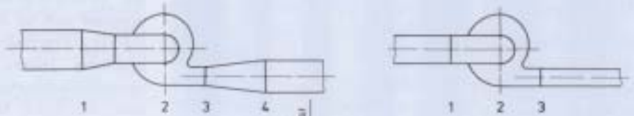
Bild D-3: Saug- und druckseitig angeschlossenes Gebläse (z. B. Saugzug-Gebläse)
